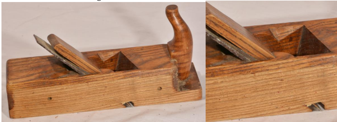
Falshøvel med skråstilt tann med klaff. Ein komplisert høvel å laga. Høvel nr.23
