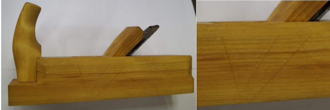
Merkeriss for senga til høveltanna, kilegangen og sponutkastet
