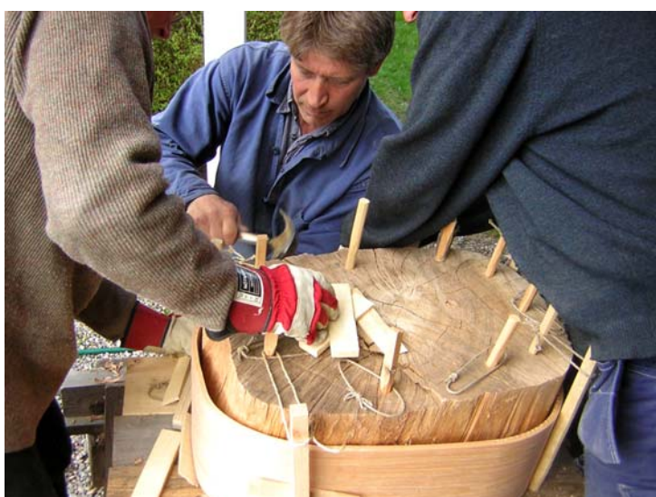
Bild 69. Svepning av spannämne på mall efter förlaga av Nils Teolin. Furu 2 Foto: Jonas Karlsson
