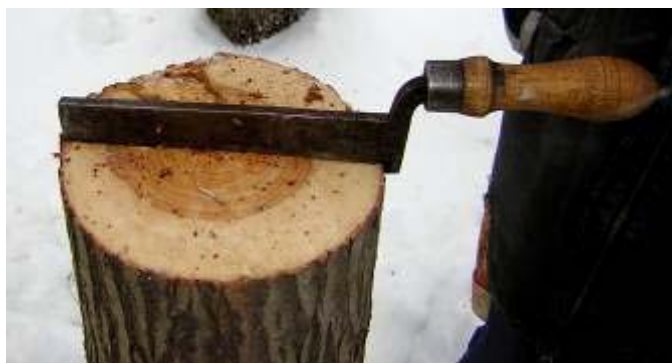
Bild 33. Markering med klyvkniv, Sälg 1. Foto: Tomas Karlsson
