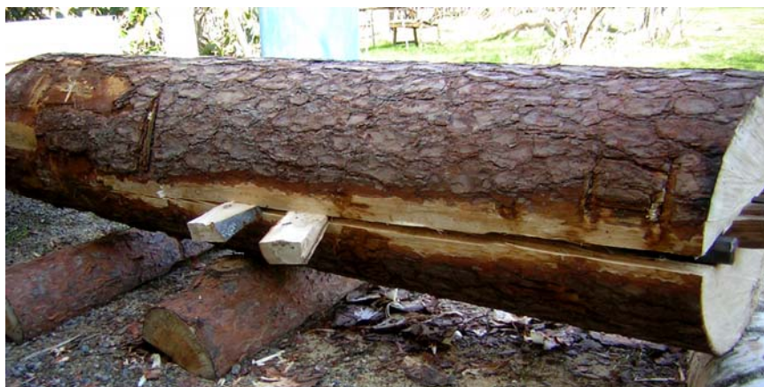
Bild 40. Klyvning av furustock 2 som visade sig vara vänstervriden, solvind.
