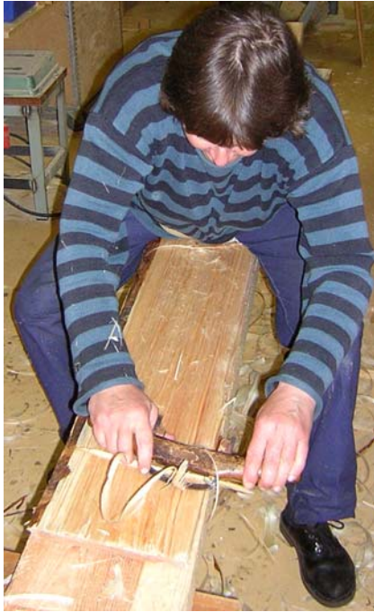
Bild 64. Avverkning med skaven på spann- ämne från furustock 2. Foto: Tomas Karlsson
