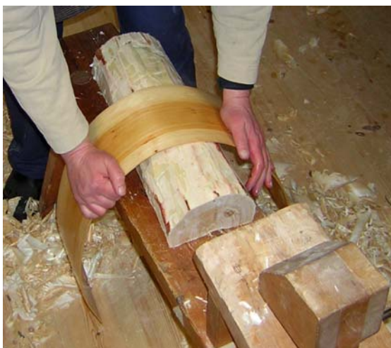
Bild 66. Manuell uppmjukning, sälg 1. Foto: T. Karlsson
