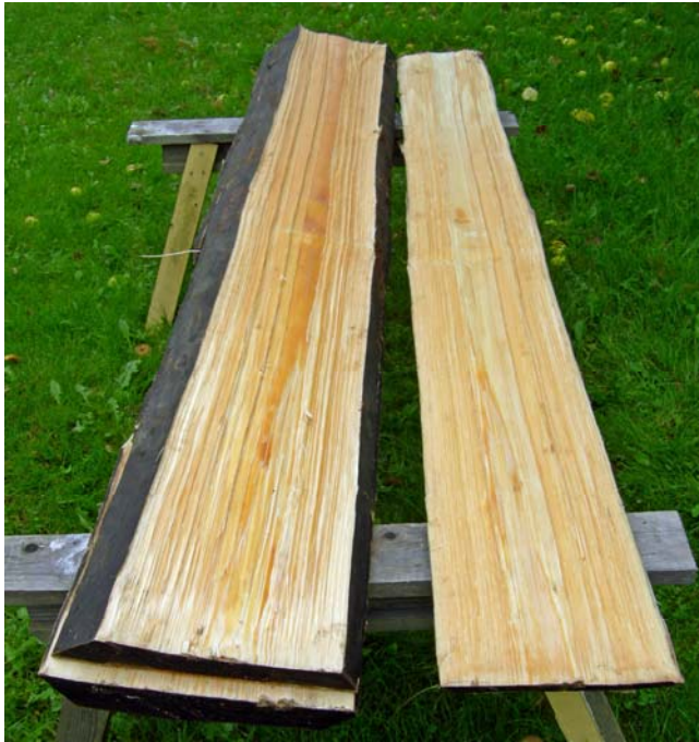
Bild 53. Kluvna brädor ur ett ämne som legat i bäcken i närmare fem månader. Furustock 4 Foto: H. Åberg
