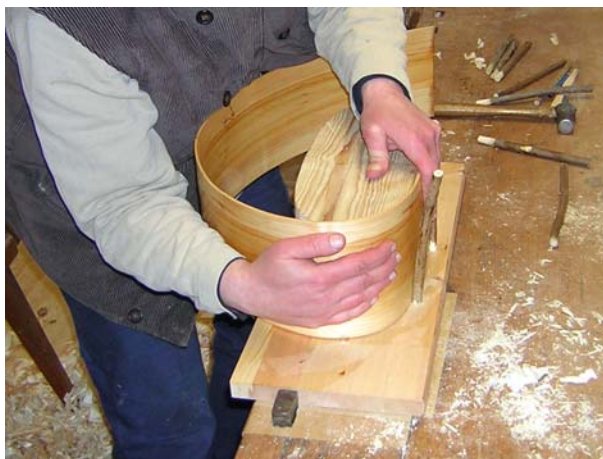
Bild 68. Svepning av sålgspån runt pinnmall. Foto: T Karlsson
