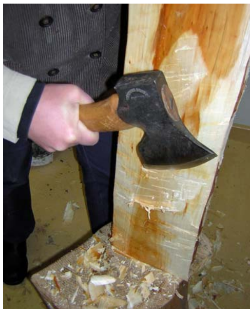
Bild 60. Avverkning med yxa, sälg 1. Foto: T. Karlsson
