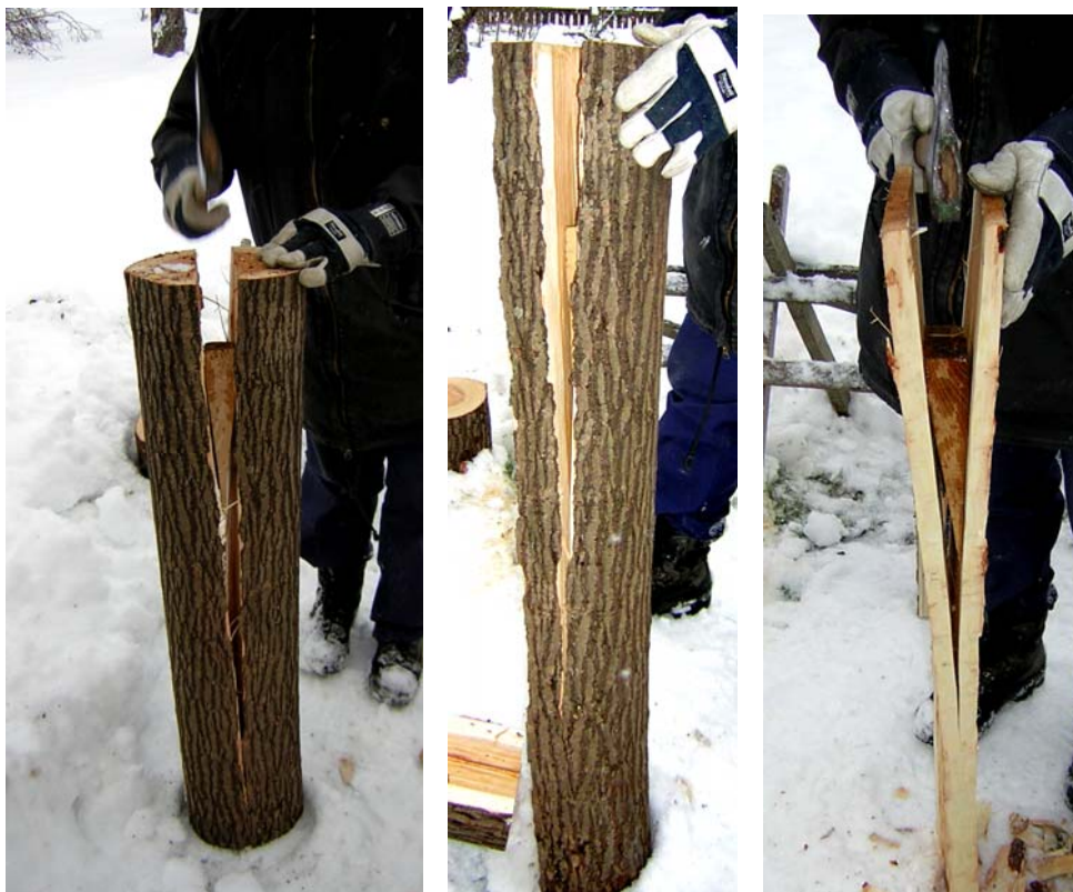
Bild 34-36. Mittklyvning samt två ytterligare klyvningar i säl 1. Barken har enligt Tage Lundqvist den typ av bark "grönsälga" som hans källa Sven Nilsson ansåg vara lämplig för klyvning. Foto: Tomas Karlsson
