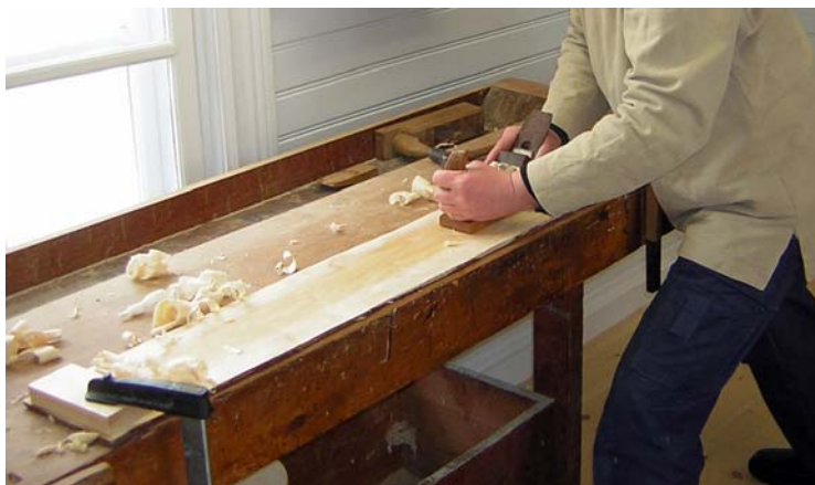
Bild 62. Hyvling av ett tunt svepämne, fastspänt från ovansidan med en tving. Foto: T. Karlsson
