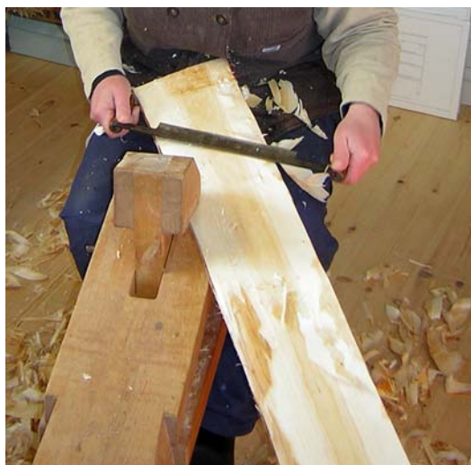
Bild 62. Bearbetning med bandkniv, sälg 1 Foto: T. Karlsson
