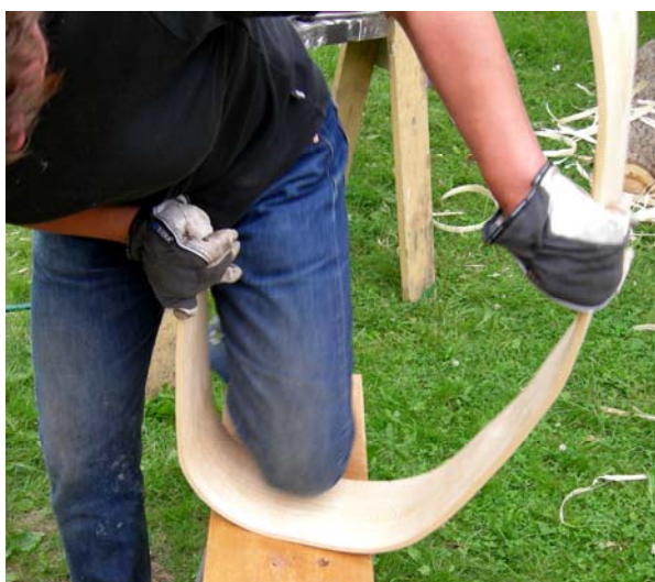
Bild 70. Vikning på frihand av spannsvep efter Våmhusmodellen. Furustock 5. Foto: Tomas Karlsson
