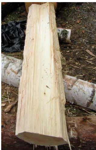
Bild 47. Ämne med bortkliven inved från roten, furustock 2. Foto: H. Åberg
