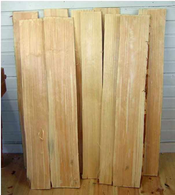
Bild 58. Furuspån ur en kvart i furustock 3A. Foto H. Åberg
