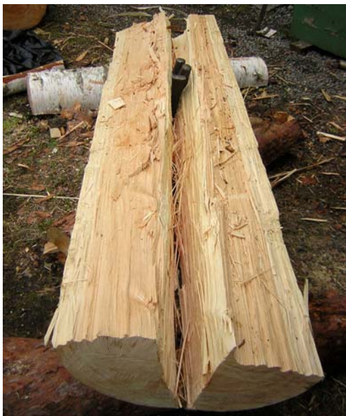
Bild 44. Kvartklyvning från rot, furustock 2. Foto: Helena Åberg
