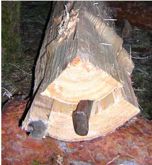
Bild 45. Bortklyvning av kärna längs årsringarna. Furustock 1. Foto: Tomas Karlsson
