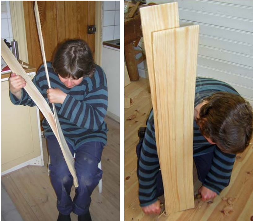
Bild 55 och 56. Handrivning av furuspån där den sista biten klyvs med spänkniv. Foto: Tomas Karlsson
