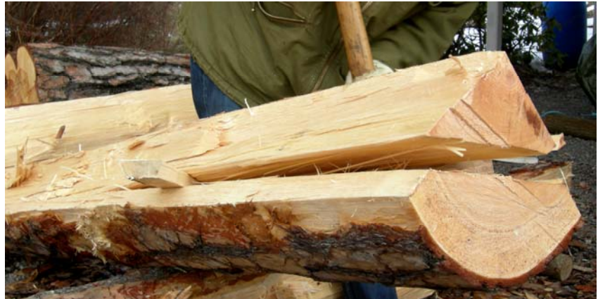
Bild 46. Bortklyvning av inveden i ett triangulärt stycke. Furustock 5. Foto: Kurt Nyberg
