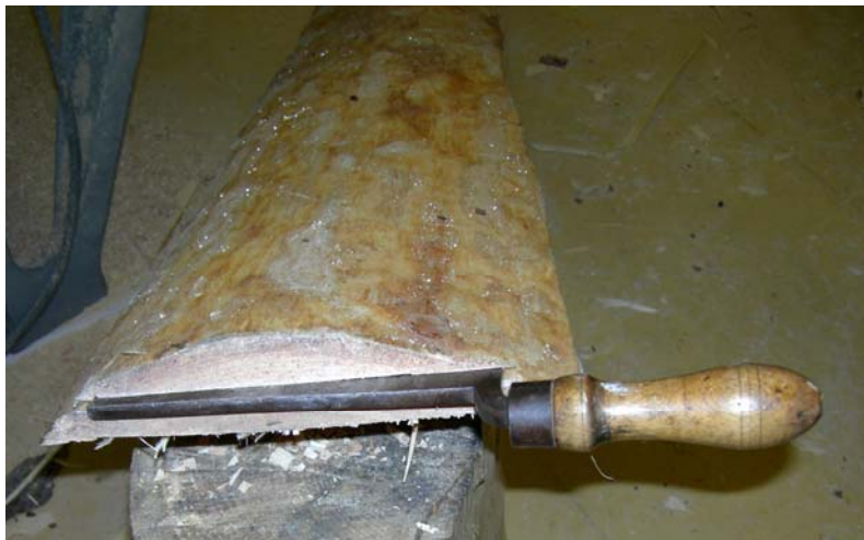
Bild 48. Markering för klyvsprickan vid klyvning av spannsvep. Furustock 4. Foto: Helena Åberg
