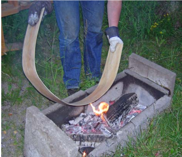
Bild 67. Basning av spån över öppen eld. Foto: T. Karlsson
