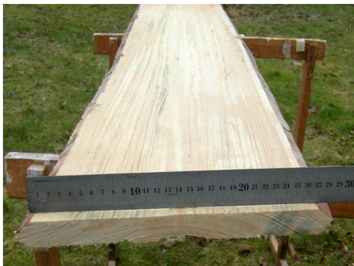
Bild 75. Bräda från Furustock 3 som trots att den förvarats under olika fuktförhållanden inte slagit sig. Tyvärr var stocken angripen av blåträ. Därför blev det aldrig aktuellt att svepa från den. Foto: H. Åberg
