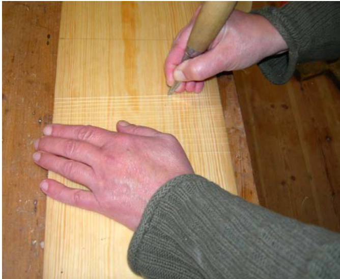
Bild 65. Ristning för hörn på spannämne, furustock 4. Foto: T. Karlsson
