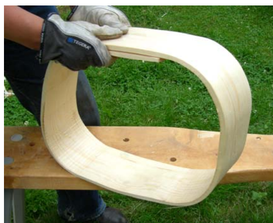
Bild 71. Hopslagning av ändarna. Foto: Tomas Karlsson
