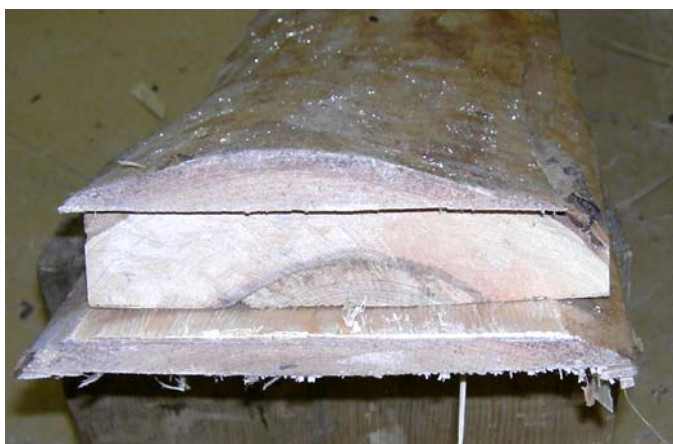
Bild 49. Fortsatt klyvning med bred kil. Furustock 4. Foto: H. Åberg
