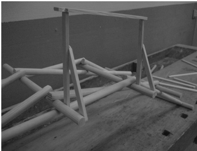
Bild 42: Förslag till broräcke som sitter utanför bron .
