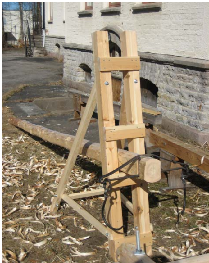
Bild 89: Trefoten är vinklad något bakåt med hävarm och krok.
