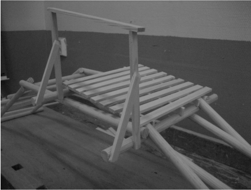
Bild 44: Brodäck och räcke. Räckets ska vara mera inbyggt än på bilden. Höjden på räckets är i verkligheten 110-120 cm över brodäcket.
