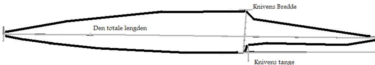
Figur 4.2 Knivblad med mål som viser hvor det er tatt mål.
