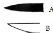
Figur 4.4 knivenes bladform A: spiss bladform B: skjærende bladform
